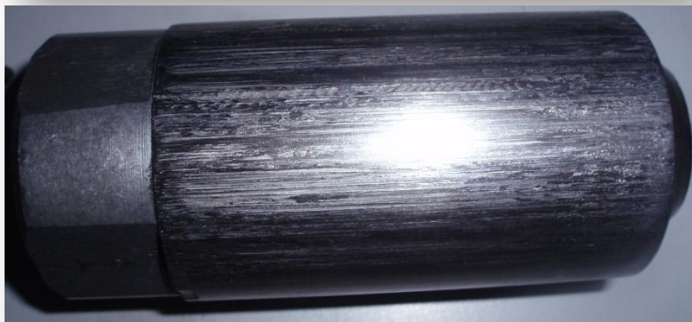
图8-1 未經過LGM處理，9599模次時磨損狀況，已開始卡沖頭
