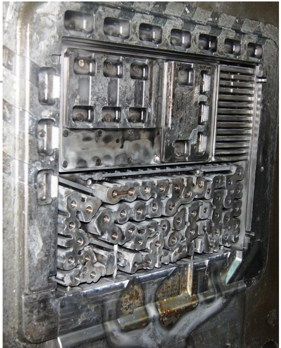
滤波器模芯/ 流道粘铝、热龟裂
