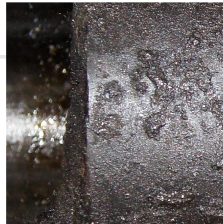
图3-1 未处理模具钢表面化学腐蚀严重
