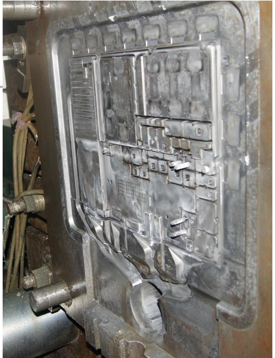
浇口套严重粘铝、拉花；顶针弯曲
