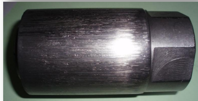
图8-2 LGM處理，40832模次時磨損狀況，未卡沖頭，仍在使用中
