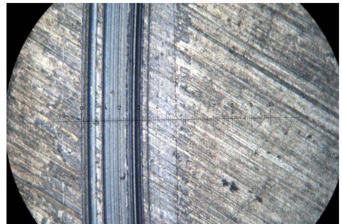
图7-2 LGM钢环磨痕，宽度0.35mm
