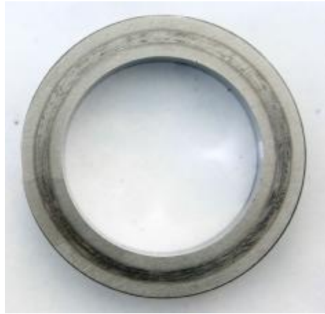
图 2-5. \Phi 54 空白 20CrMo 渗碳钢大环磨损后, 磨痕宏观图
